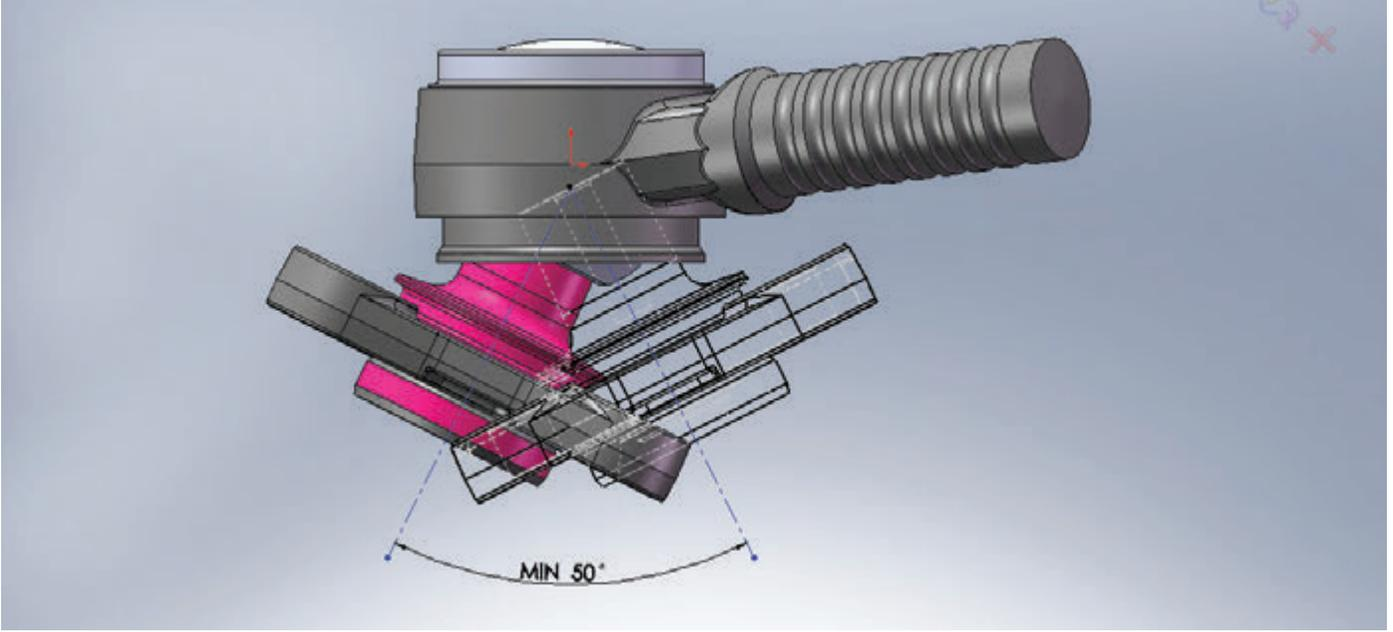
**ROTA, off road ve ağır hizmet tipi araçlar için yeni geliştirdiği patentli ‘teflon yataklama’lı V kol ile ürünlerin çabuk aşınmasını engelleyerek daha uzun kullanım ömrü sunmaktadır.**
