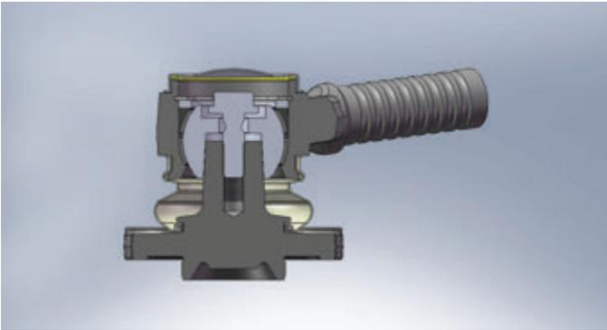
Buna ek olarak yapı içerisinde küresel bölgenin sonunda bulunan çentik ve yük etkisinden dolayı yatak malzemesi zaman içinde deformasyona uğramaktadır. ‘Teflon yataklama’ ile V kolun çalışması sırasındaki salınım açısı genişletilmiştir. Böylelikle birim yüzeye düşen yük taşıma kapasitesinin artırılması sağlanmış olup, salınım açısı 44°’den 50°’ye çıkartılarak V kol’un daha esnek hareket edebilmesine olanak sağlanmıştır.
